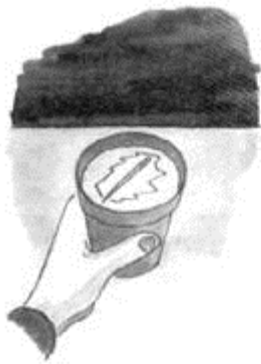
Slika 14: Namagnetena šivanka se zasuče v smeri sever – jug
